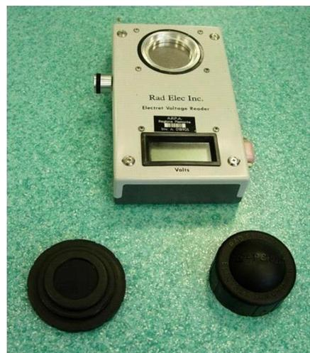
**Fig. 3.:**misuratore di concentrazione radon
