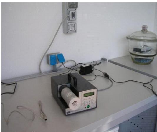
**Fig. 2.:**misuratore in continuo del gas radon
