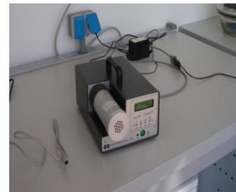
*misuratore in continuo del gas radon*
