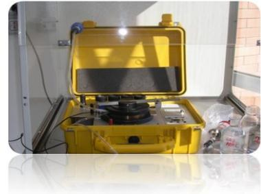
*misuratore di concentrazione di attività di radon in acqua*
