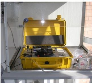
*misuratore del gas radon in acqua*
