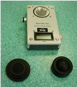
*contatore di carica ed elettretti passivi per la misura del radon*
