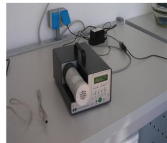
*misuratore in continuo del gas radon*
