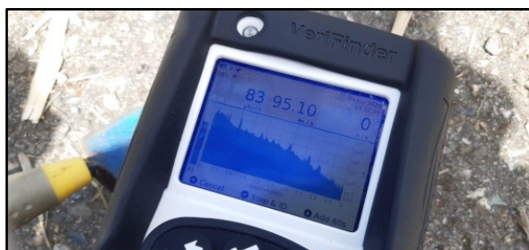
Figura 8 -spettrometro Verifinder con sonda al bromuro di lantanio
