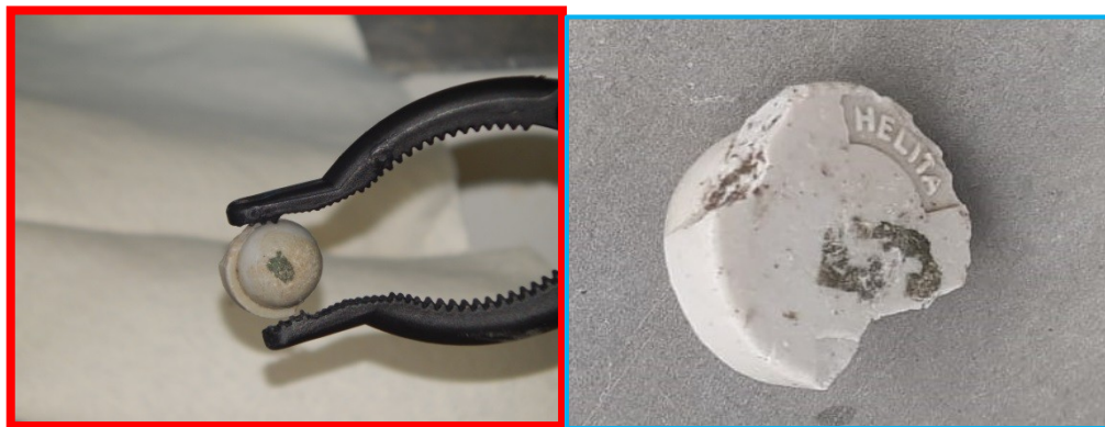
Figura 5 – capsula di radio 226 appartenente alla testata di un parafulmine Helita G
