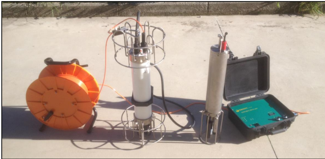
Sonde Idronaut Ocean Seven 316 e Sea & Sun CTM 90 ed unità telemetrica
