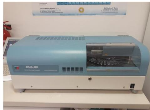
**Figura 6** – DMA-80 Analizzatore diretto di mercurio utilizzato per l'analisi del mercurio nei mitili Lab. Chimico-Tossicologico DAP CZ
