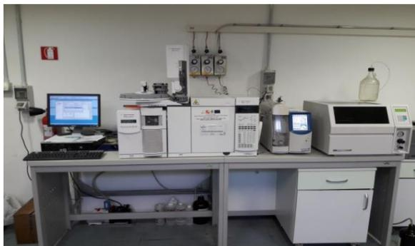
**Figura 5** – GC/MS accoppiato ad un sistema "Purge & Trap" utilizzato per l'analisi dei Composti Organici Volatili – VOC - Lab. Chimico-Tossicologico DAP CZ
