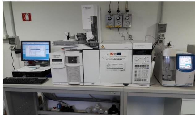
**Figura 4** – GC-MS/MS utilizzato per l'analisi di IPA, Pesticidi, Fenoli presenti nella colonna d'acqua - Lab. Chimico-Tossicologico DAP CZ
