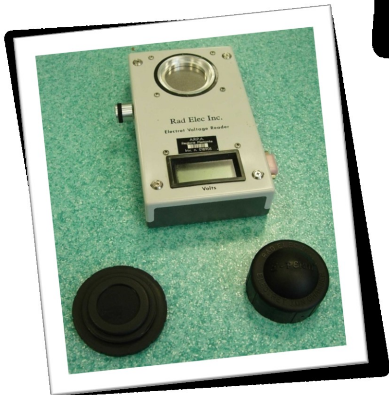
dosimetri ad elettrete per lunga durata (long term)
