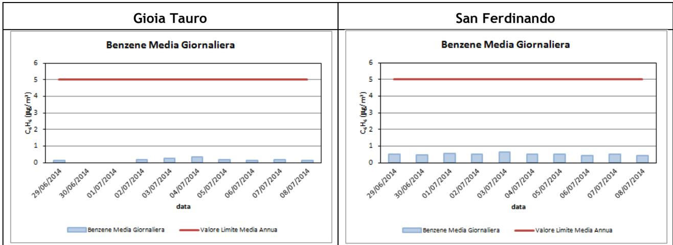
Durante il periodo di osservazione, per alcuni giorni, non è stato possibile analizzare tale parametro a causa di avaria strumentale dell'analizzatore, per cui alcuni dati non sono disponibili.
