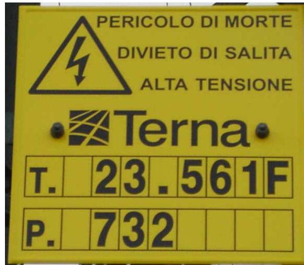
Esempio di nuova targa, presente sui sostegni delle linee di Terna Rete Italia S.p.A., che riporta il numero del sostegno (P. 732) e il numero della linea (T. 561).
