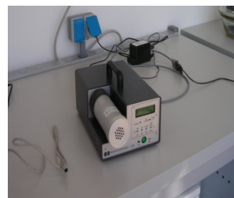
misuratore in continuo del gas radon
