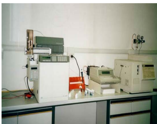
Figura 3: Gas cromatografo con sorgente radioattiva di Ni 63
