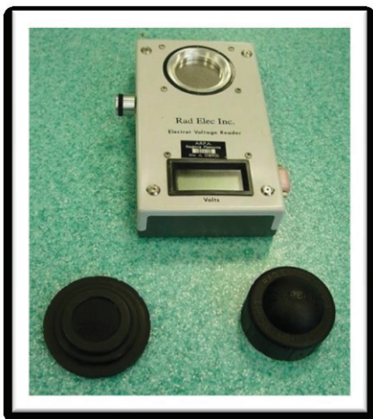
misuratore di carica per la concentrazione di radon
