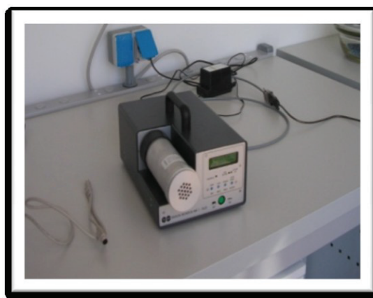
misuratore in continuo del gas radon
