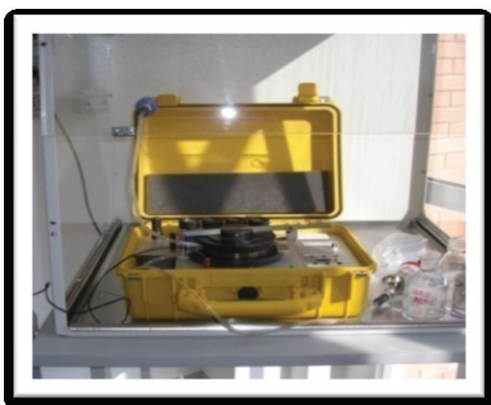
misuratore del gas radon in acqua
