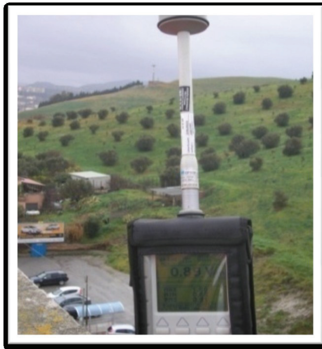
misuratore di campi elettromagnetici con sonda per le alte frequenze
